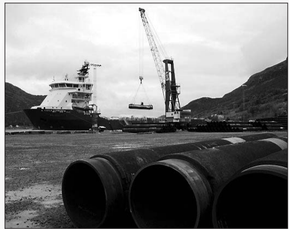
Lasting: Krana løftar to og to røyr om bord i Havila Harmony. Løftereiskapen som NorSea har utvikla gjer at krana utfører alle operasjonar sjølv, og ein treng difor ikkje å ha nokon til å feste og løyse røyra
