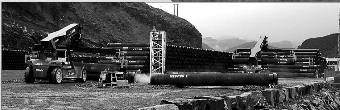
Klargjering: Alle røyra vert reingjort og kontrollert før dei vert henta av ein av dei store truckane på hamneområdet. Truckane tek med seg røyra vidare til lasteområdet og dei to kranane på hamna
