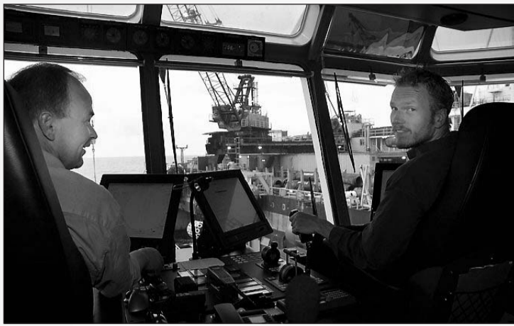
Brua: Kaptein Inge Eriksen (t.v.) og 1. styrmann Bjørn Brattheim har lagt Havila Harmony trygt attmed LB 200. Den 92 meter lange supplybåten er utstyrt med system som sender ut laserstrålar og mikrobølger mot ein refleksor på LB200. Desse systema gjer at båten ligg perfekt i forhold til rørfartyet under heile lossinga. Ei lossing tek gjennomsnittleg 12 timar
